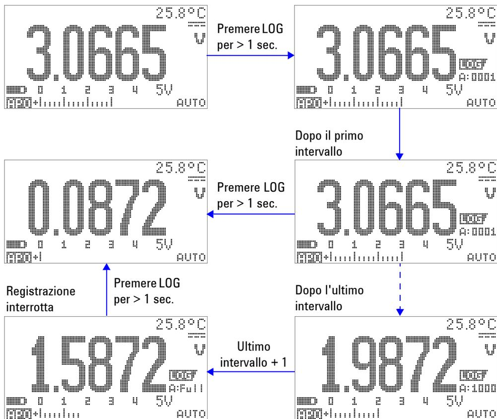
**Figura 3-10** Funzionamento in modalità di registrazione a intervalli (Time)
