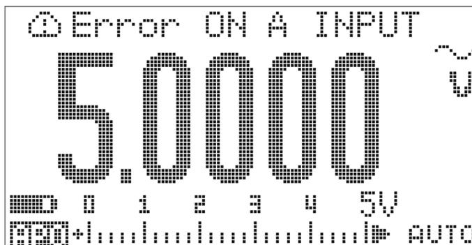
**Figura 6-2** Messaggio di errore per terminale di corrente
