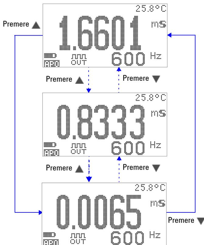
Figura 3-14 Larghezza d'impulso per l'onda quadra in uscita
