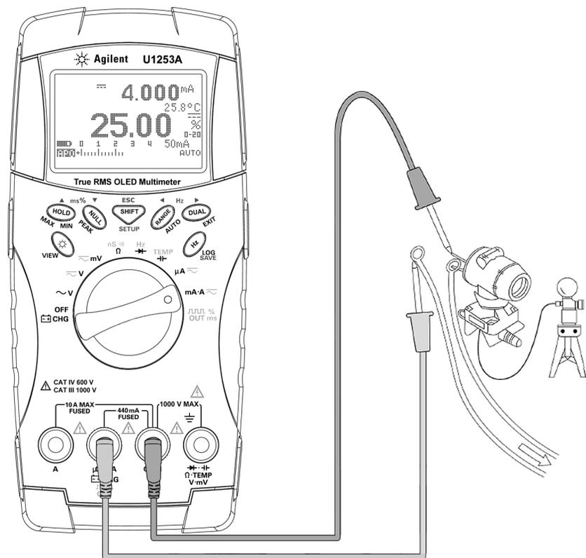
Figura 2-4 Scala di misurazione da 4 mA a 20 mA
