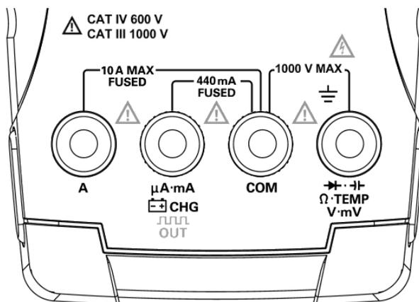
Figura 1-5 Terminali del connettore
