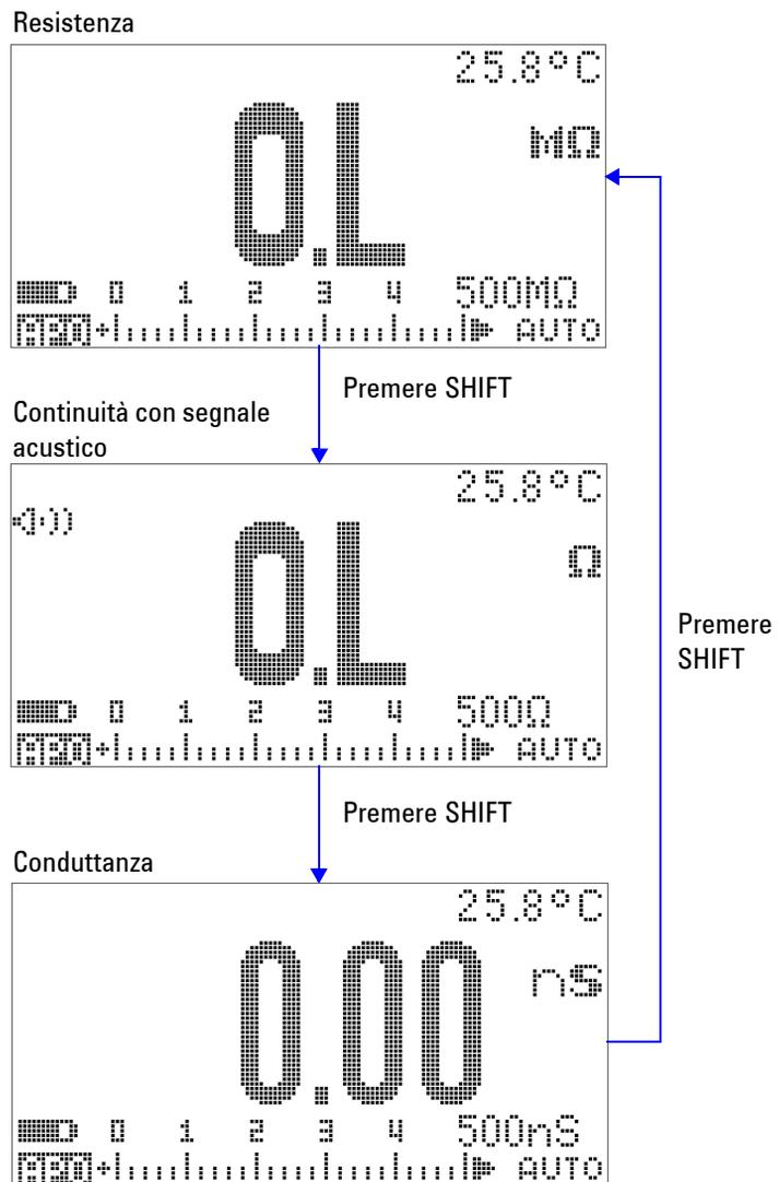
**Figura 2-8** Test di resistenza, continuità con segnale acustico e conduttanza
