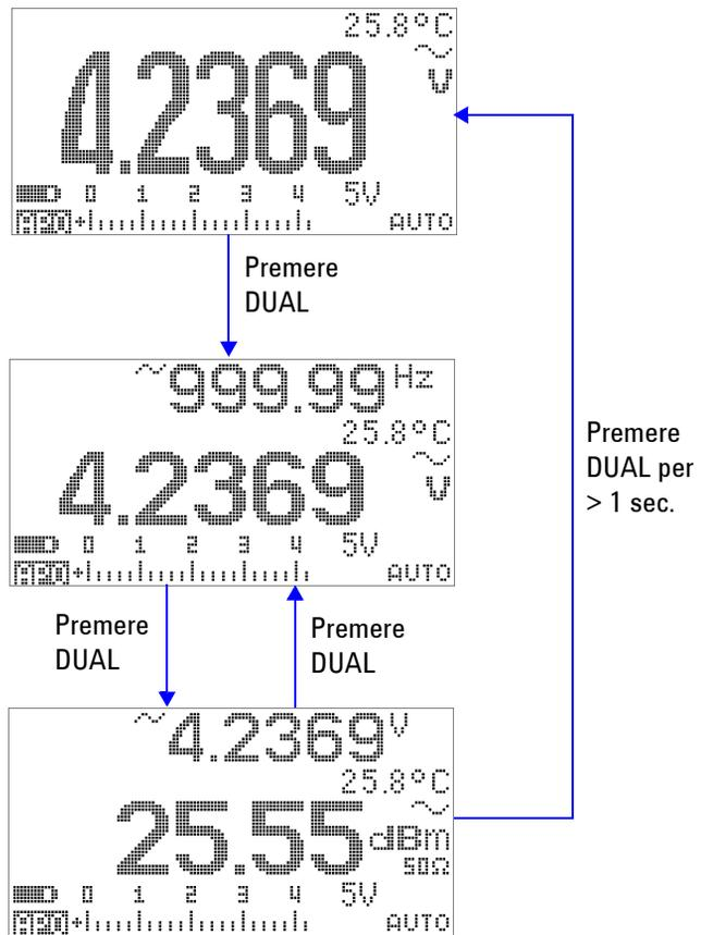
**Figura 3-5** Funzionamento in modalità di visualizzazione dBm
