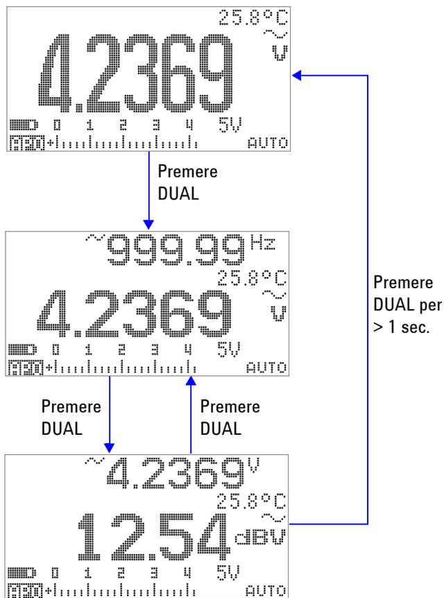
**Figura 3-6** Funzionamento in modalità di visualizzazione dBV
