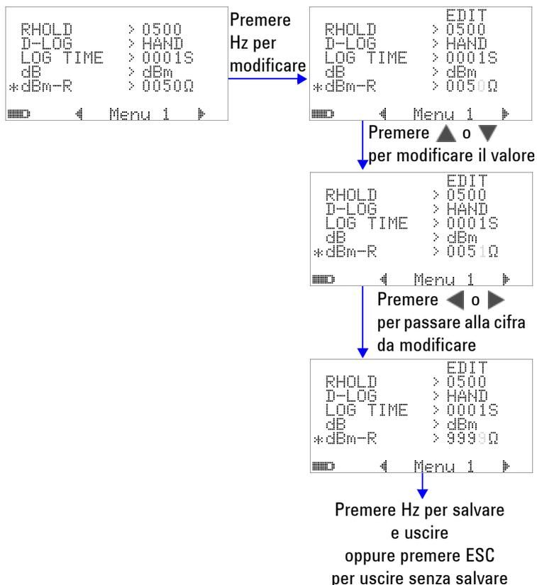
**Figura 4-6** Impostazione dell'impedenza di riferimento per l'unità dBm
