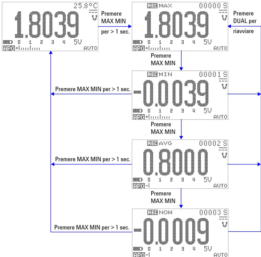
Figura 3-1 Funzionamento in modalità Dynamic Recording
