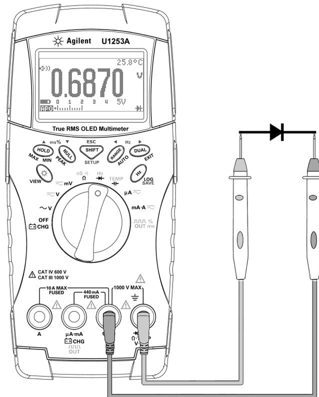
**Figura 2-10** Misurazione della polarizzazione diretta di un diodo
