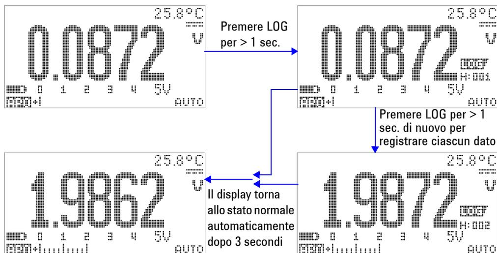
**Figura 3-8** Funzionamento in modalità di registrazione manuale (Hand)
