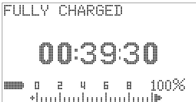
**Figura 5-5** Carica completata e in stato di mantenimento
