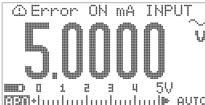
**Figura 6-3** Messaggio di errore per terminale di carica
