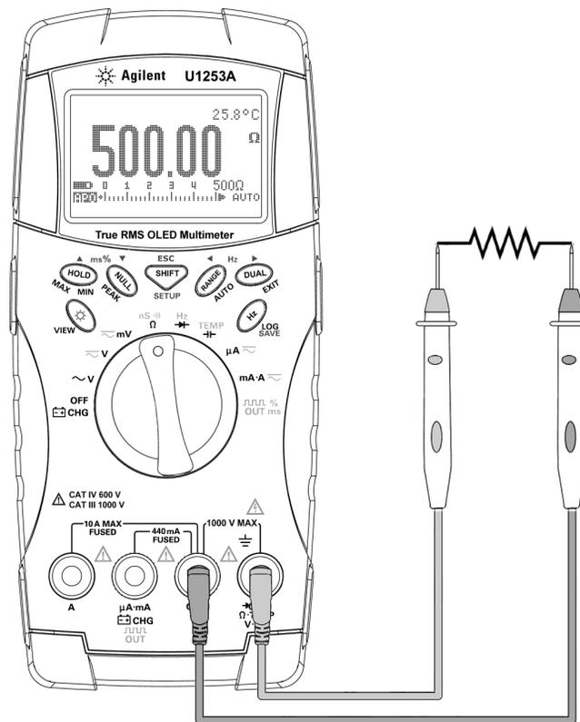
Figura 2-7 Misurazione della resistenza
