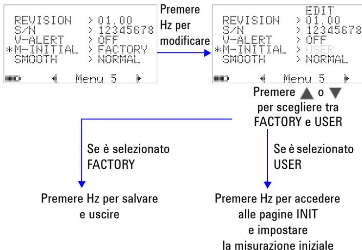
**Figura 4-25** Impostazione delle funzioni di misurazione iniziale
