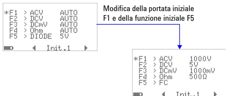
**Figura 4-27** Modifica della portata/funzione di una misurazione iniziale
