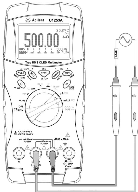
**Figura 2-3** Misurazione della corrente  $\mu\text{A}$  e mA
