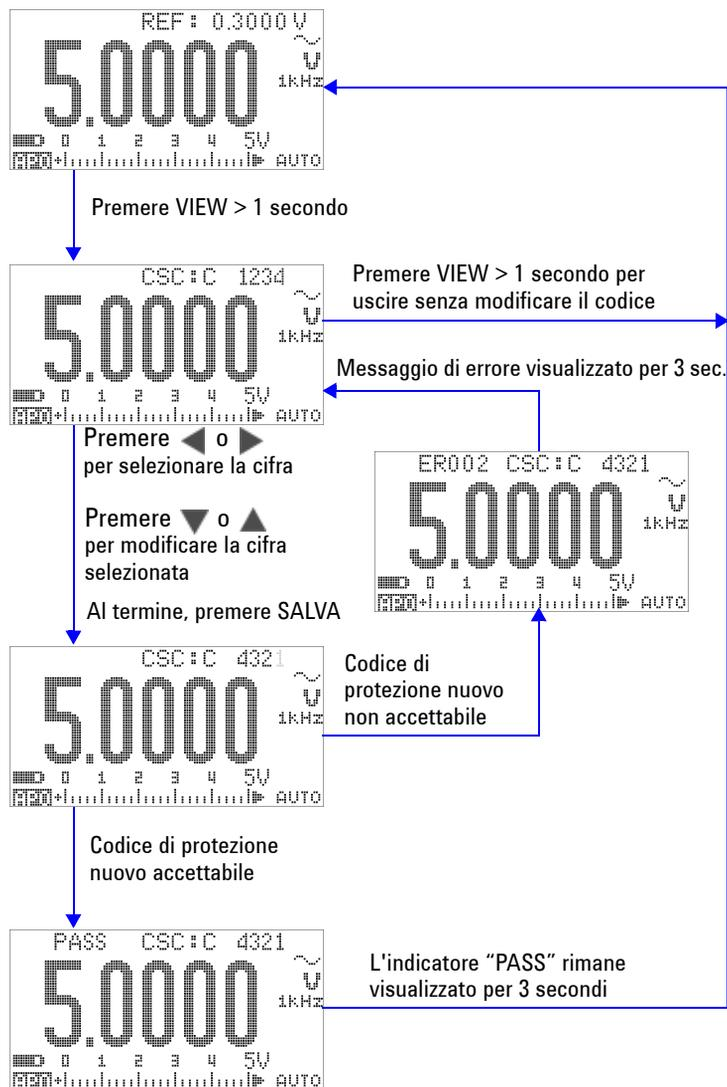
Figura 6-5 Modifica del codice di protezione della calibrazione
