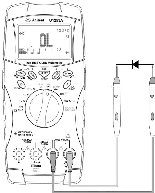
Figura 2-11 Misurazione della polarizzazione inversa di un diodo
