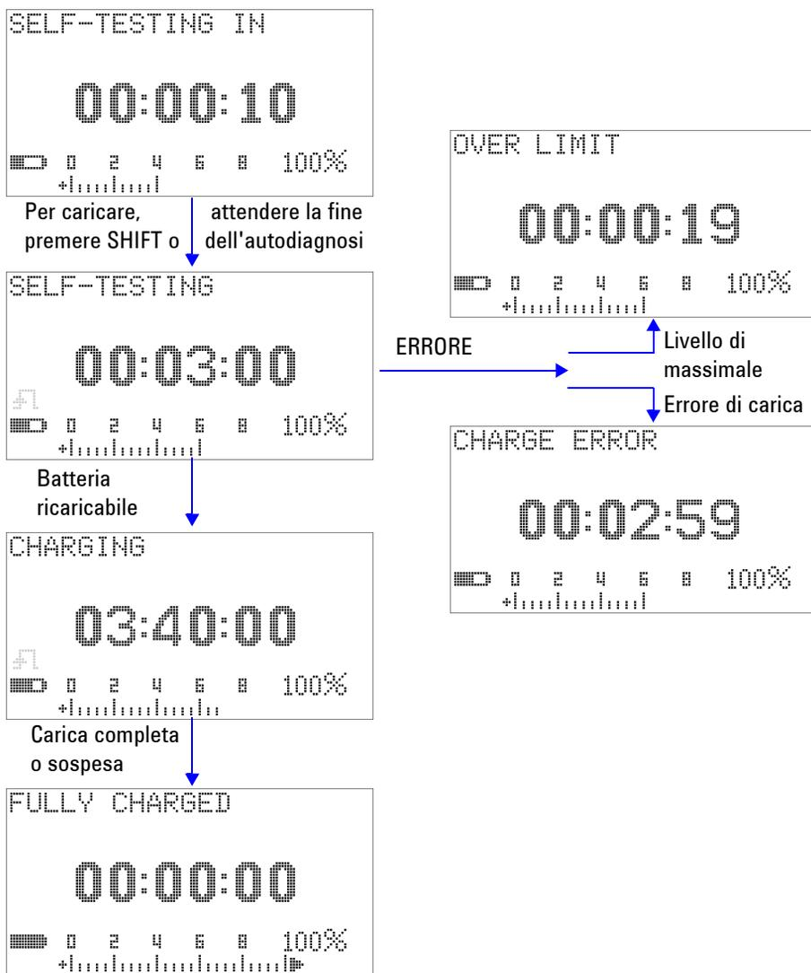
**Figura 5-6** Procedure di carica della batteria
