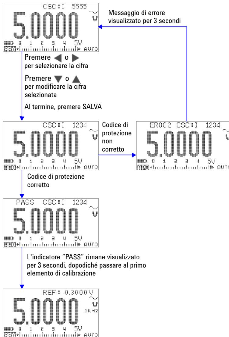
**Figura 6-4** Rimozione del blocco di protezione per la calibrazione dello strumento
